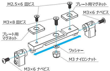
フロント側のボディマウントプレートを組み立てます。マウントプレートの中央にある M3 ナットを緩めることで、プレートの幅を変更できます。お好みに合わせて調整し、使用してください。両側の M3x6 ナベビスを緩めることで、プレートの角度の調整も行えます。
