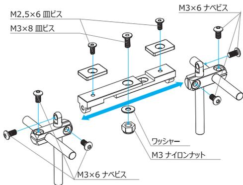
リア側のボディマウントプレートを組み立てます。マウントプレートの中央にある M3 ナットを緩めることで、プレートの幅を変更できます。お好みに合わせて調整し、使用してください。プレートを支持しているクランプで、マウントプレートの位置や角度を調整できます。
