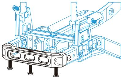
注意：必ず付属のスクリューを使用し、組み立てて下さい。
